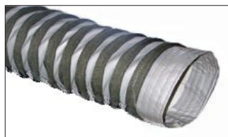
SPIRA- EXHAUST для отвода: с плотной спиралью, устойчивой к вакууму PVC (+100°C), CSM (+175°C), стеклоткань (+800°C)
