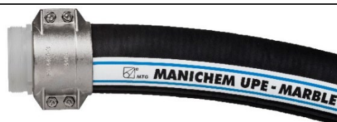
Шланг MANICHEM MARBLE DN75 с фитингом с наружной резьбой 3" BSP из полипропилена, зажат скорлупчатой обоймой из нержавеющей стали TI-SC-075-080-SS.
